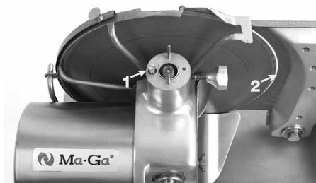
Rys. 11. Osłona ostrza i wkręt regulacyjny
