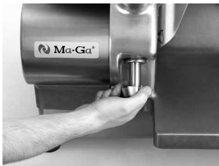
Rys. 9. Odkręcanie śruby ściągającej
